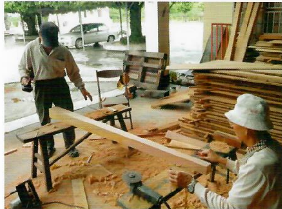
舵軸形狀削削上寬下窄
