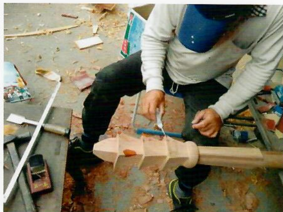
用快乾點梳斗四角，避免乾燥龜裂， 保護尖端
