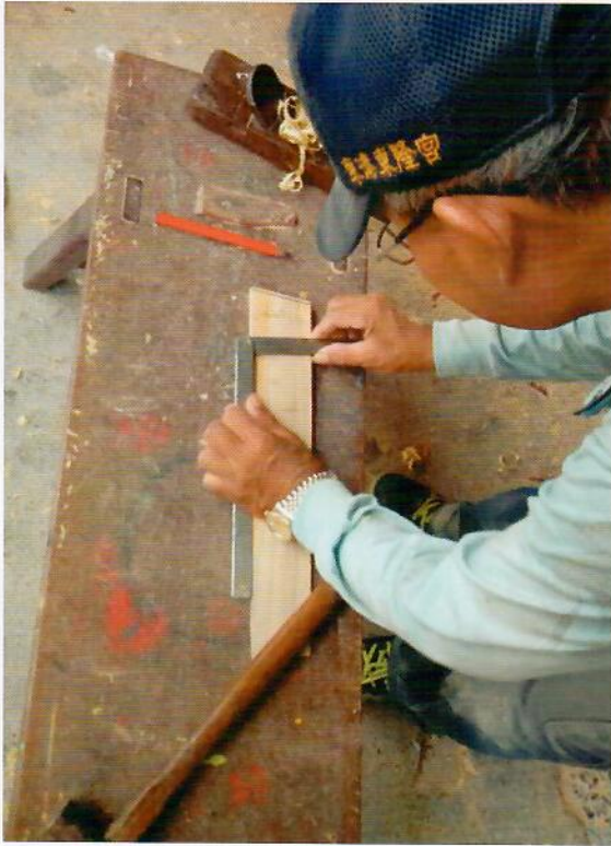
量取模板上大刀頭中段的角
