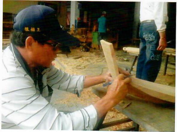
小艇船艙組裝測試，畫出需整修處
