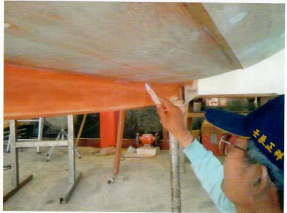
「水底」與龍骨接縫塗上一層薄白 膠，形成薄膜，避免木柴持續乾燥時， 出現細縫
