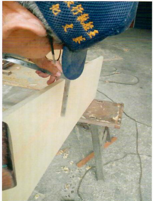
測量並修整大刀頭中段角
