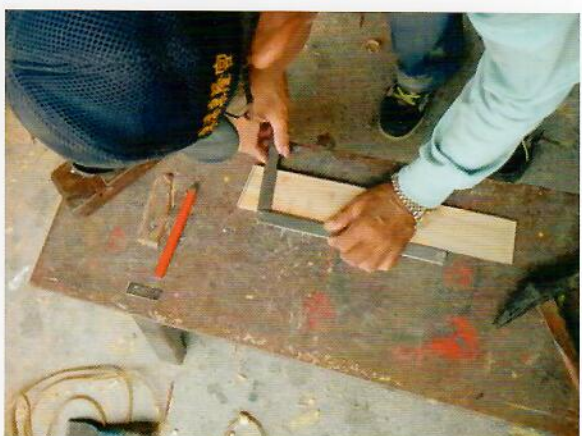
量取模板上大刀頭尾部的角度
