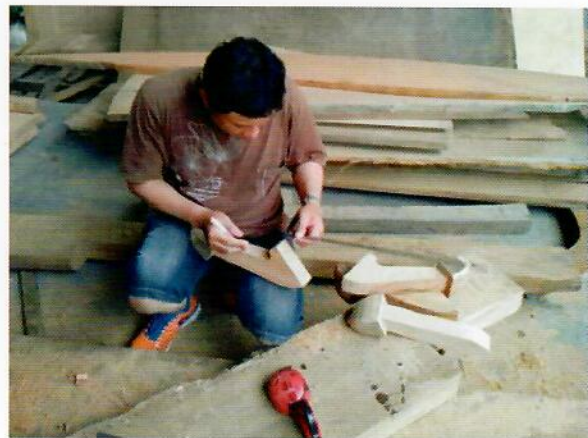
錨臂打磨後測量尺寸
