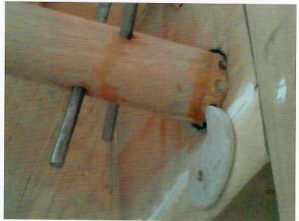
「魯拉」固定器，卡住「魯拉」，在其升降後能固定。
