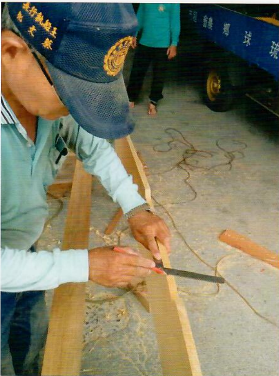
測量大刀頭底部 日月樑後段小缺塊的角--1
