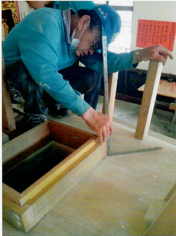
艙堵口安裝測量，量出底部與甲板弧度的出入，使艙堵口與甲板能密合
