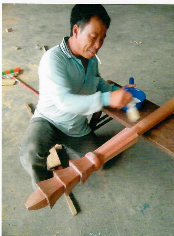
梳身上白膠水，白膠水乾後形成薄膜 包住梳身，避免乾燥龜裂
