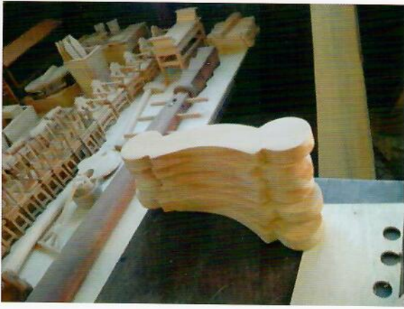
桅夾，固定在桅柱上，夾住桅桿
