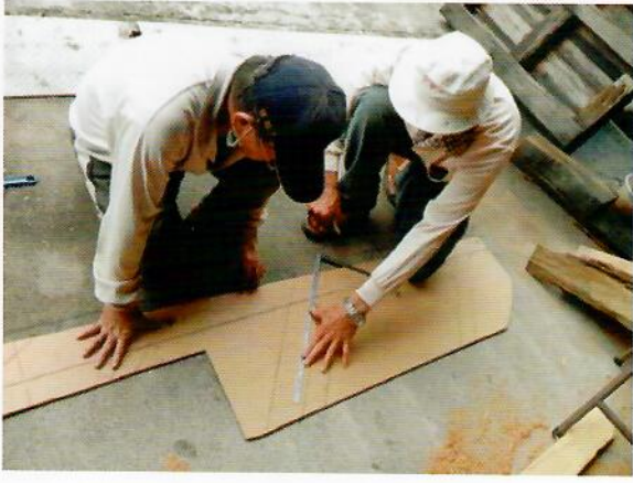
舵葉模板測量
