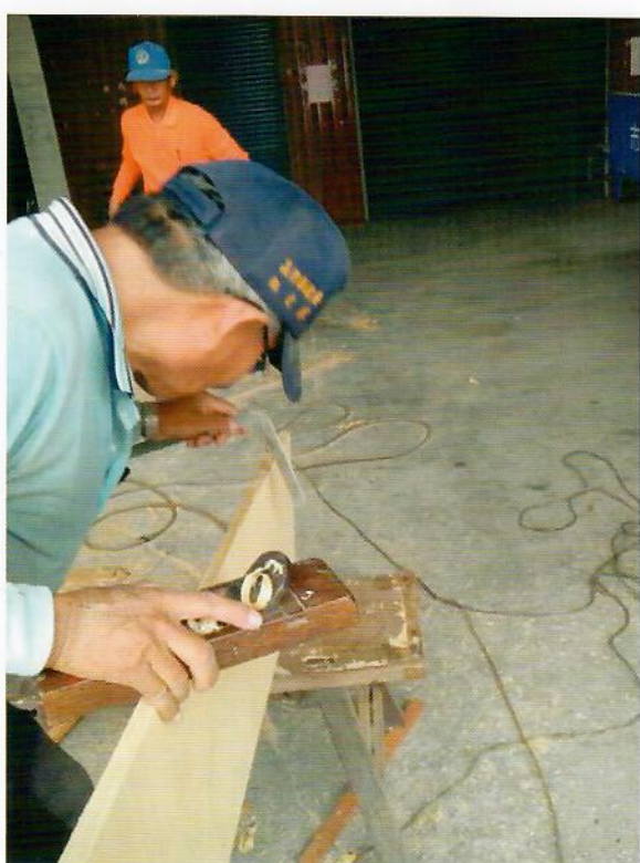
測量並修整大刀頭尾部角度
