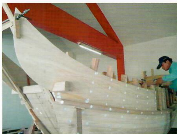
大刀頭安裝完成—左側
