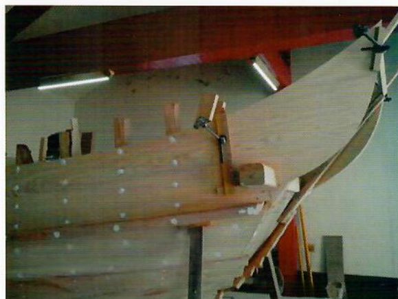
大刀頭安裝完成—右側
