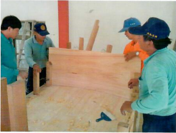
五王層隔板削整後 測量底部與船身是否緊貼
