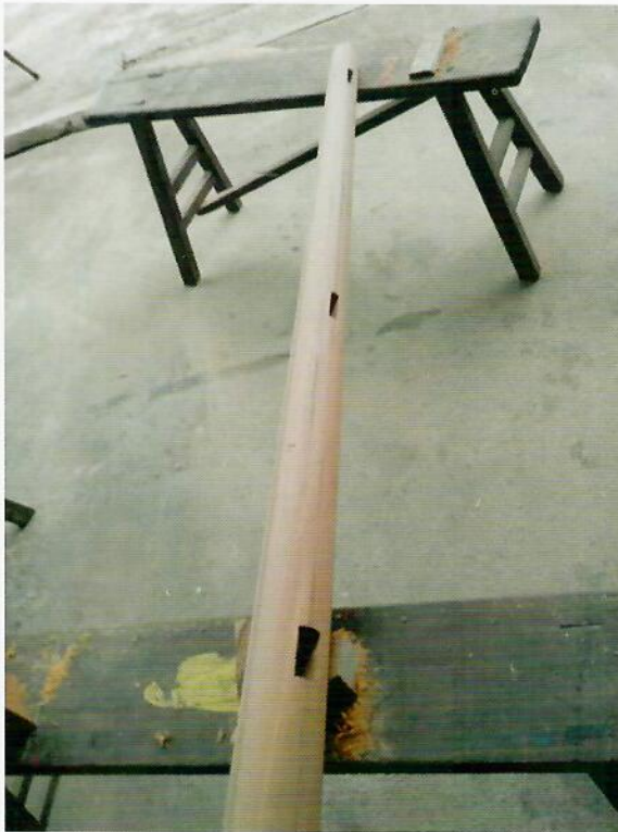
舵軸製造完成
