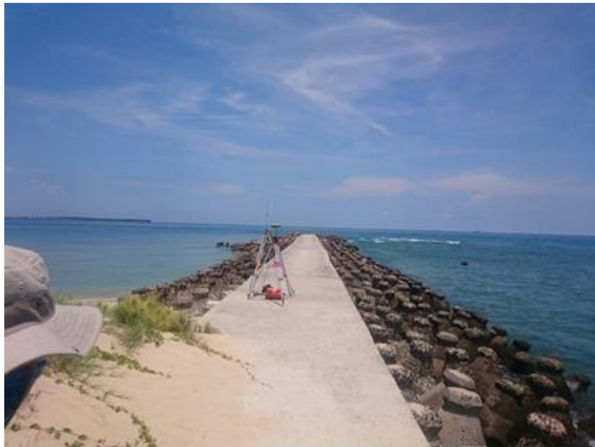
圖十三、RTK-GPS 基準站架設(隘門沙灘)
