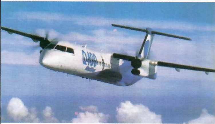
📷 Le Bombardier Q400 est un bi-moteur à hélice.
