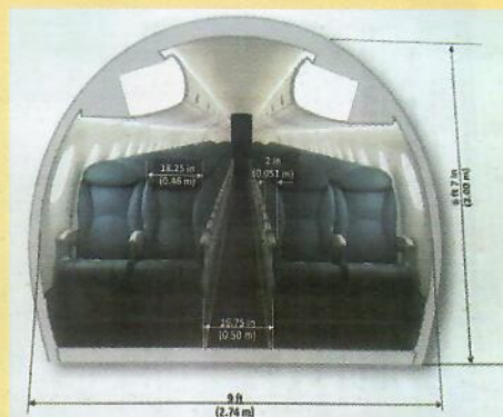
La cabine de l'Embraer 175, en coupe (ci-dessus) et vue du dessus (ci-dessous)
