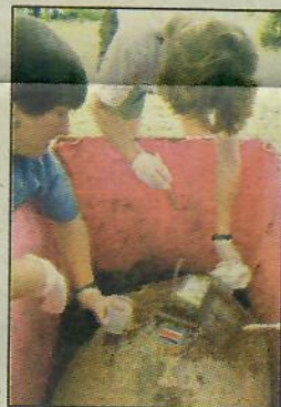
3: El transmisor se protege con fibra de vidrio y resina.
