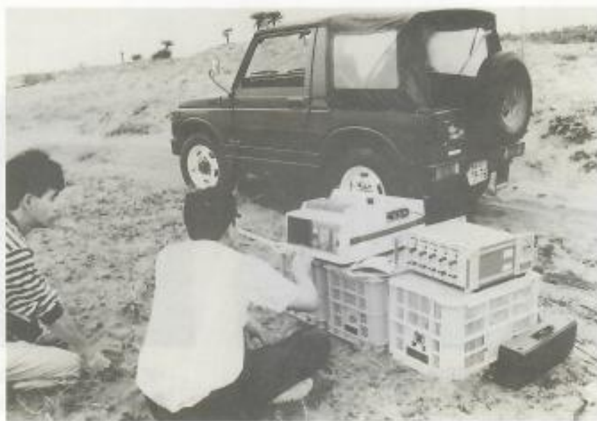
砂の上を走る四輪駆動車が砂中に加える圧力を測定する
