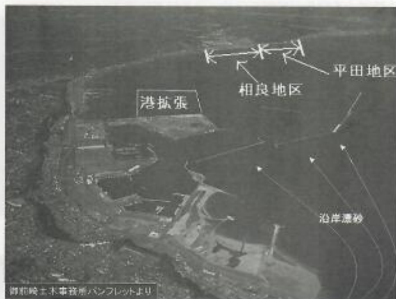
(写真②) 西方の天竜川から流れ込む沿岸漂砂の流れと人工構築物
