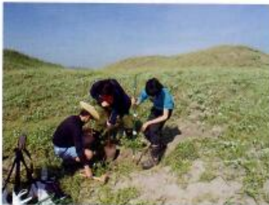
砂中温度計の設置
