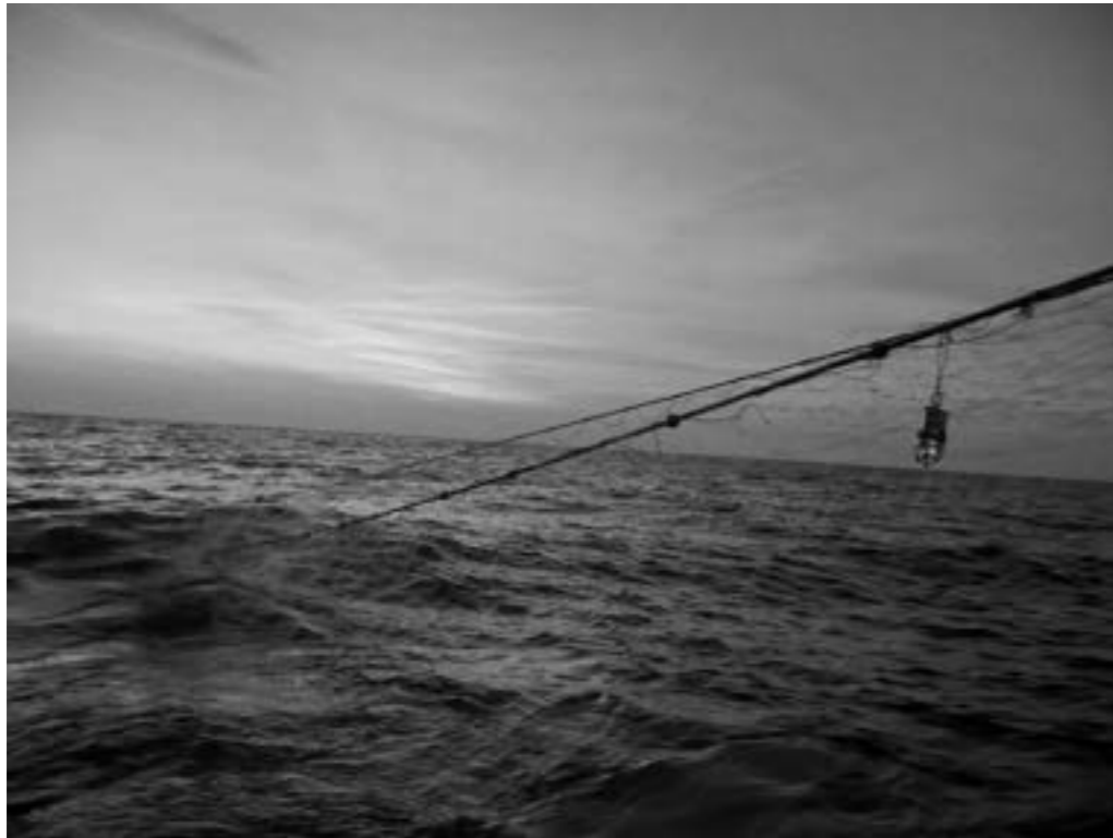
▲ 초록 LED등을 단 자망. 10m에 한 개 단 것으로도 바다거북, 상어 등이 잘못 걸리는 일이 상당 부분 차단됐다. (한겨레신문 : 제시 센코 제공)
