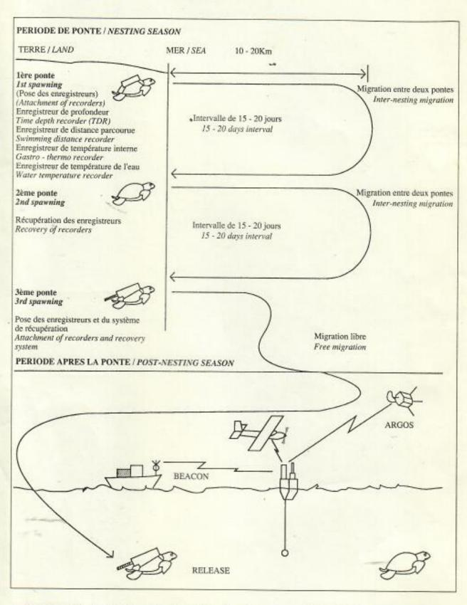
ler août, grâce au détecteur d'émission radio et sans recourir au système Argos, l'avion a aisément repéré la première balise qui dérivait à 20 km au sud de la zone de ponte. Le bateau a ensuite récupéré la balise d'après les indications fournies par l'avion. Il a fallu attendre
